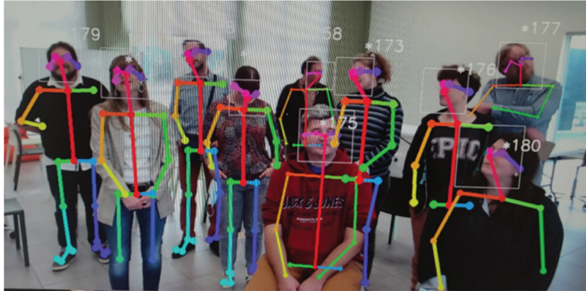
Figure 5 Un identifiant est attribué à chacun suivi long terme plus robuste. Suivi basé sur des squelettes dans un environnement de groupe complexe (en termes d'occlusions) utilisant la REID de visage
