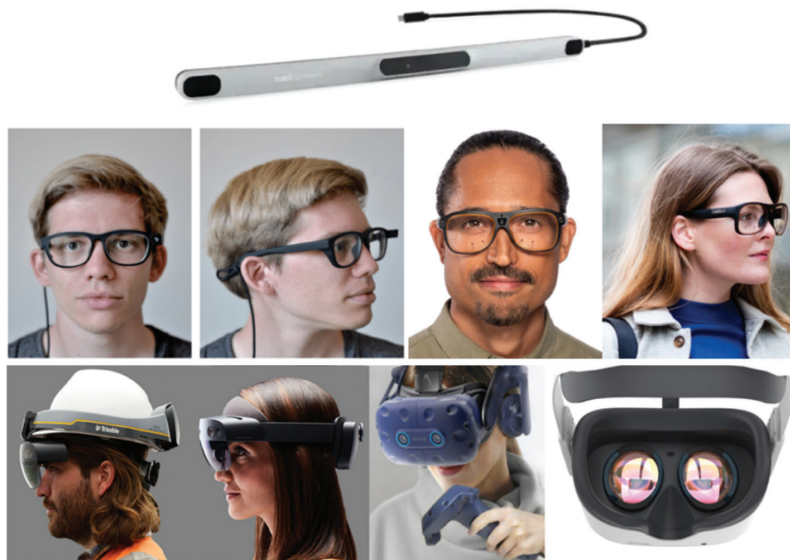
Figure 10 Haut: barrettes de suivi du regard (ici Tobii PCEye), milieu: lunettes de suivi du regard (Pupil invisible à gauche et Tobii glasses à droite), bas (dispositifs AR à gauche et dispositifs VR à droite)
